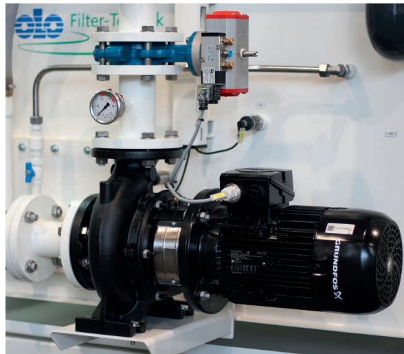
Abförderpumpe / Discharge pump
