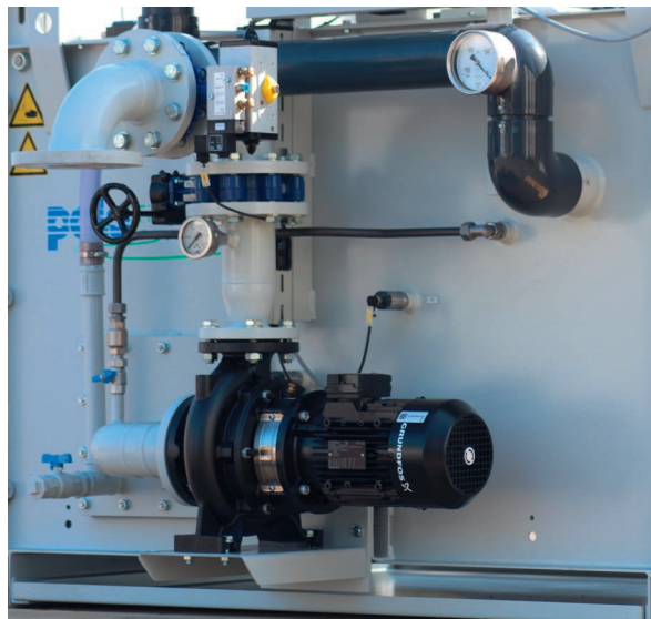
Abförderpumpe / Discharge pump
