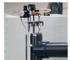
Regulador de la aspiración de aire Air intake regulator
