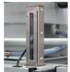
Interruptor de flotador depósito limpio Float switch clean side
