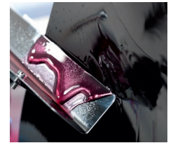
Rascador en el canalón de drenaje Stripping in the drain trough
