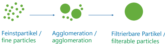
aus 1 µm bis 5 µm werden 36 µm / from 1 µm to 5 µm are 36 µm
