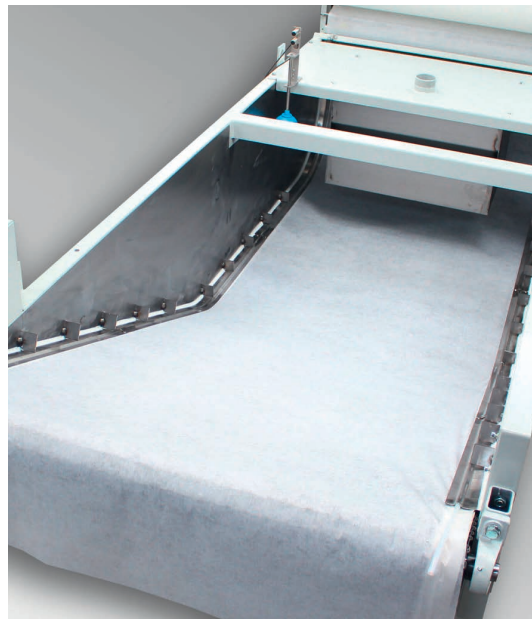
cubeta de filtración honda / deep filter trough
